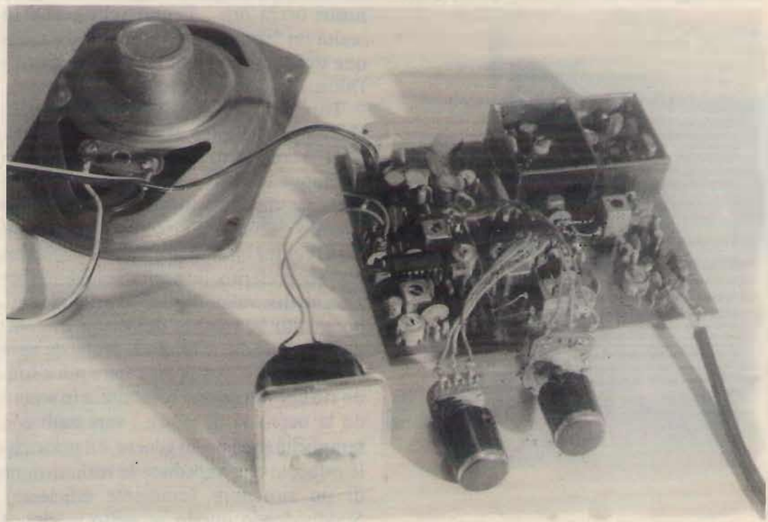
Il ricevitore "Rho Ophiuchi" già assemblato nei suoi cinque telaietti e pronto a funzionare.
